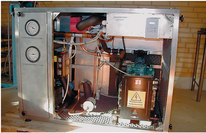
Prototypen på den behovsstyrede, modulerende varmepumpe ses her før opstillingen ved den gennemførte fieldtest. Danfoss har til projektet specialudviklet en frekvensomformer til direkte montering på den sugegaskølede Bitzer stempelkompressor. Foto: Vagn Tanderup.
